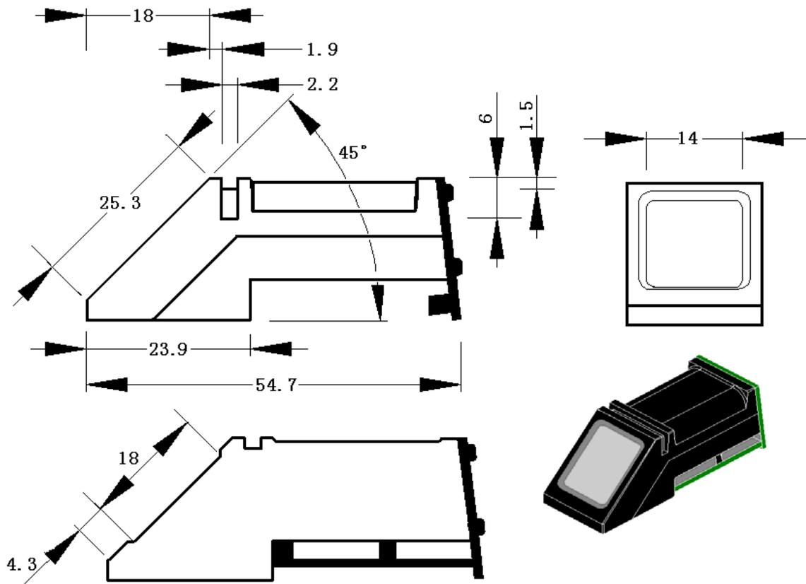
(注：此处的 54.7 加上 PCB 板，实际尺寸为 56mm)
